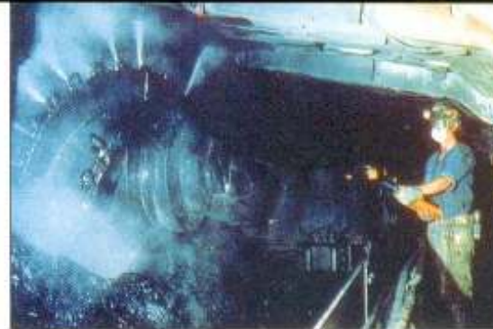
Figura 2 Máquina de corte para paredes longas ("longwall") auxiliada por "waterjet" de modo a reduzir a poeira ou fração respirável [3]
