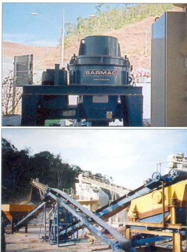
Figura 1 – Vista panorâmica (esquerda) e detalhes do circuito de britagem do CETEM para obtenção de areia artificial.
