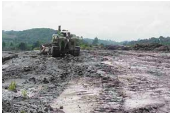
Painel lavrado e aterrado com rejeitos argilosos sendo coberto com estéril proveniente da lavra.
