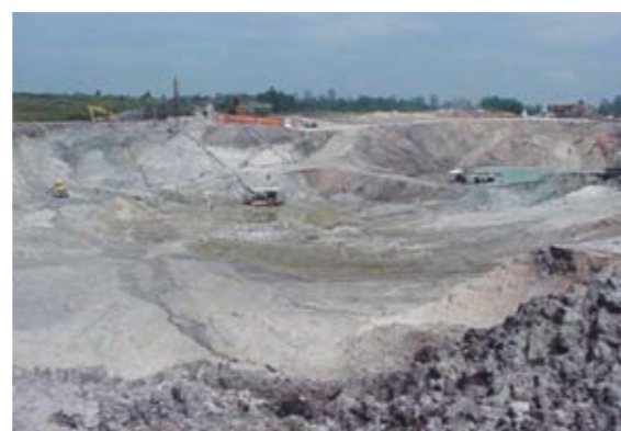
Painel em lavra no porto Ponte Alta, onde é utilizado o desmonte mecânico por trator sobre esteiras e dragagem do minério empoldado por jateamento.
