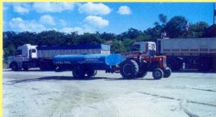
Procedimento: caminhão para umectação em vias de acesso ao empreendimento
