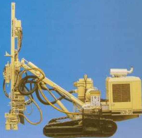
PERFURATRIZ ECM-370 Semi-hidráulica, martelo VL 140/HR diâmetro de perfuração 2 1/2" à 4" coletor de pó, compressor embarcado.
