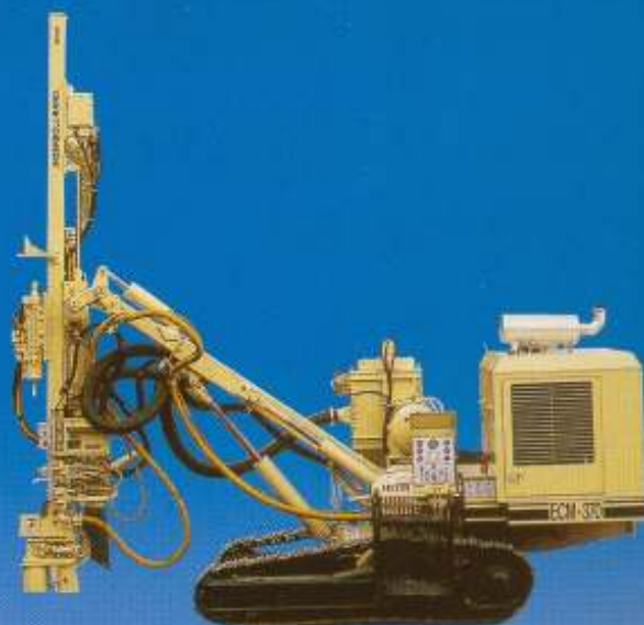
PERFURATRIZ ECM-370 Semi-hidráulica, martelo VL 140/HR diâmetro de perfuração 2 1/2" a 4" coletor de pó, compressor embarcado.
