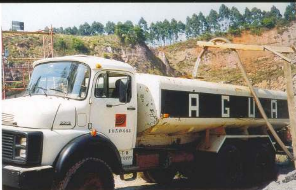
Caminhão-pipa usado no controle da poeira
