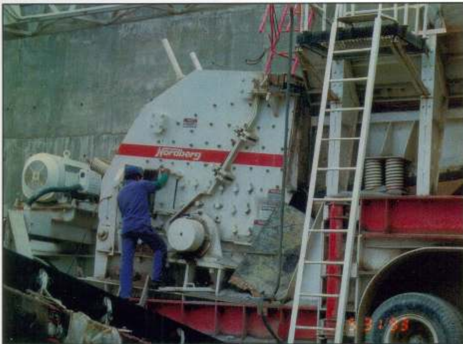
Britador do conjunto reciclador de entulho. Prefeitura Municipal de São Paulo (Usina Itatinga)
