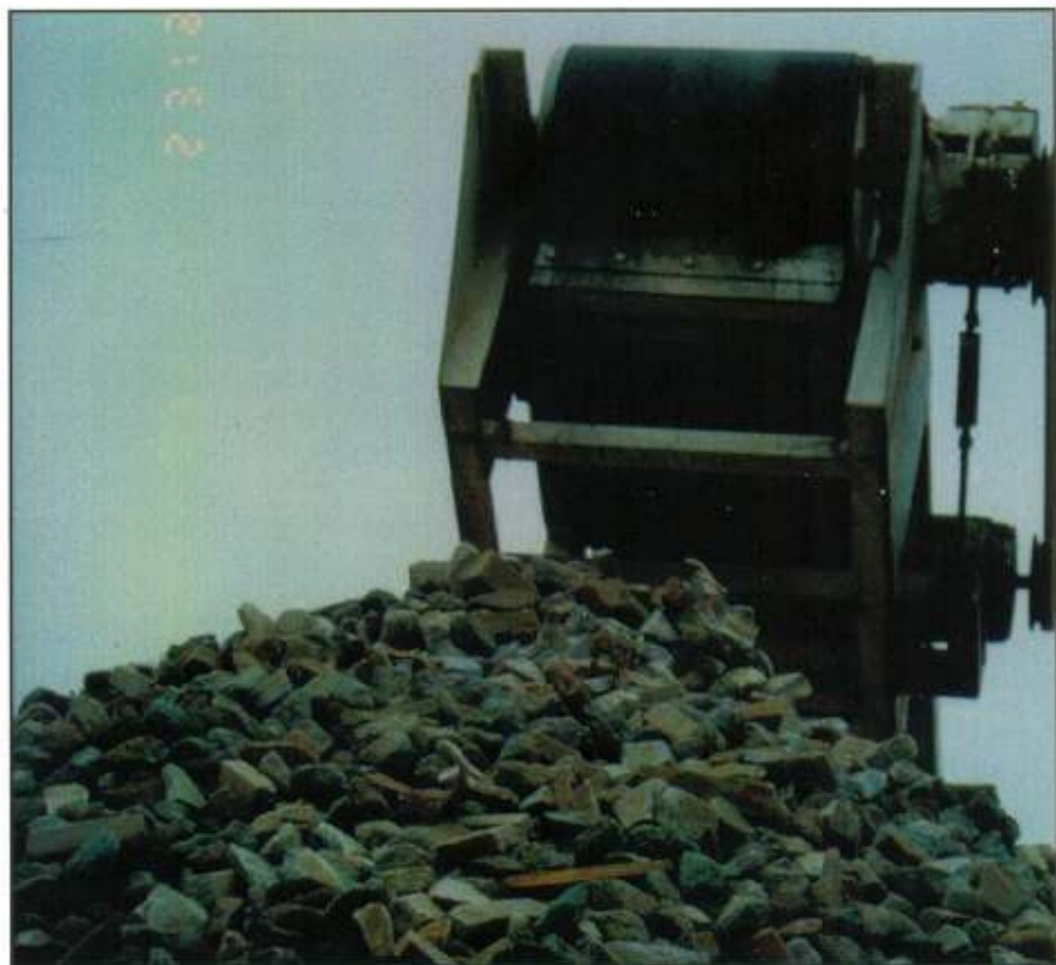
Agregado reciclado a partir de entulho (PMSP)
