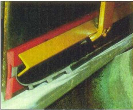
*Sistema de vedação lateral: solução para vazamentos e proteção da cinta de borracha*
