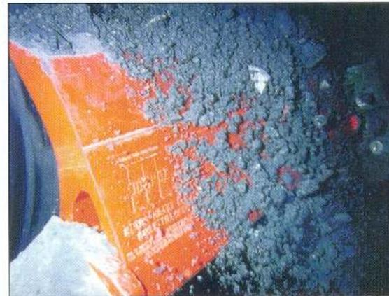
Raspador primário, retira o material em excesso aderido na correia
