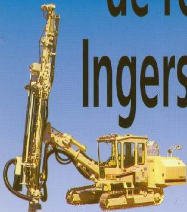
PERFURATRIZ ECM-580 Totalmente hidráulica, cabinada, diâmetro de perfuração 2 1/2" à 4" sistema de perfuração IR-MONTABERT de alta produção.
