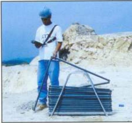
Sismógrafo são equipamentos, dotados de geofones e microfones, que permite captar as vibrações no maciço e a so-
