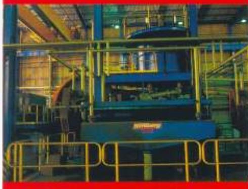
Separador Magnético da Instalação da C.B.M.M.-Araxá-MG
