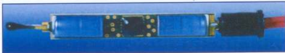
Espoleta sem a cápsula de alumínio de proteção
