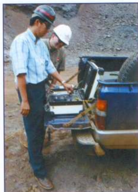
Operação da "Blasting Machine"
