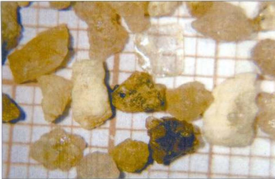
Foto 2 - Detalhe de grãos de quartzo analisados em lupa binocular.
