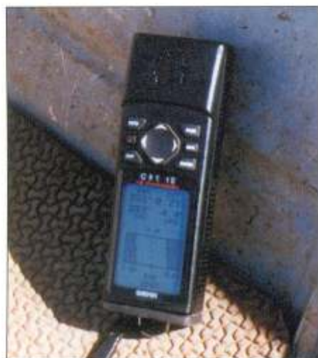
Equipamento GPS utilizado para localização de pontos e estabelecimento de rotas de navegação.
