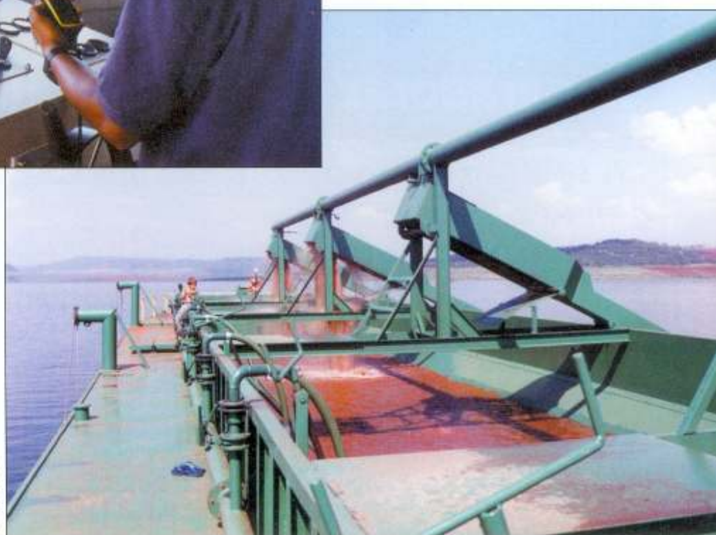
Equipamento utilizado nos testes de dragagem (draga de sucção) para determinação da espessura dos pacotes sedimentares e amostragem do material
