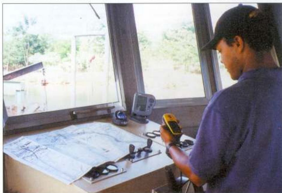
Operador de draga localizando o ponto de extração através do equipamento GPS e utilizando o ecobatímetro para melhorar a segurança durante a navegação
