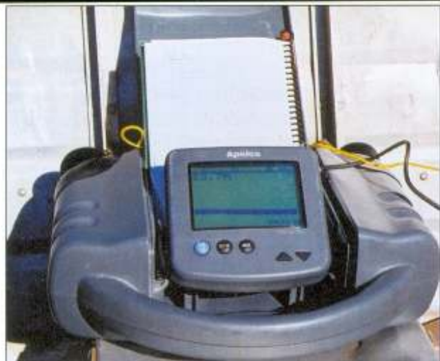
Equipamento utilizado no levantamento topobatimétrico do reservatório, mostrando a profundidade do leito e a configuração do substrato
