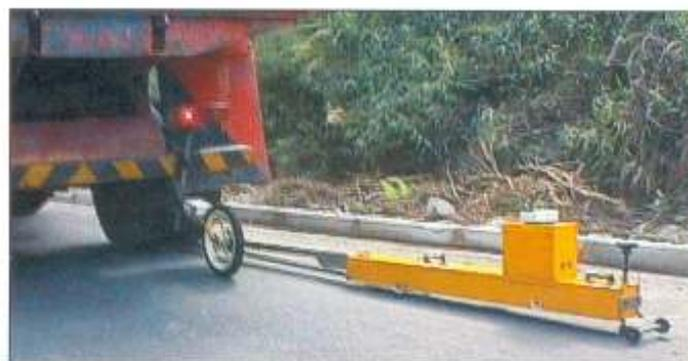
Foto 3: Detalhe de levantamento estrutural feito na via antes da execução da capa asfáltica
