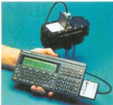
Foto 2: Detalhe de programação de um micro-sismógrafo.
