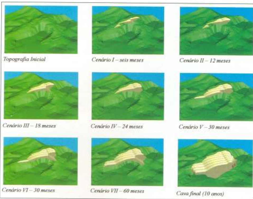
Figura 4 - Exemplo de seqüenciamento de um planejamento de lavra
