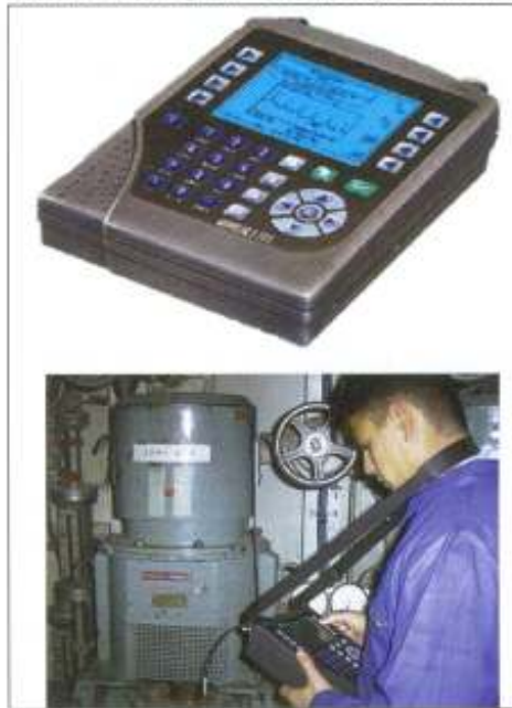
Manutenção preditiva-análise de vibrações
