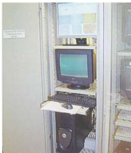
Figura 3 – Arranjo típico de múltiplos computadores para um sistema de visualização baseado no software OCS®
