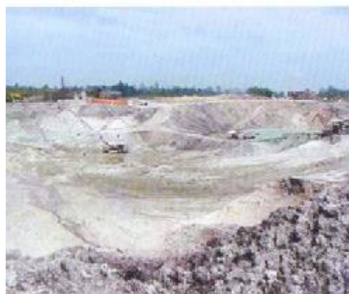
Painel em lavra no porto Ponte Alta, onde é utilizado o desmonte mecânico por trator sobre esteiras e dragagem do minério empilhado por jateamento.
