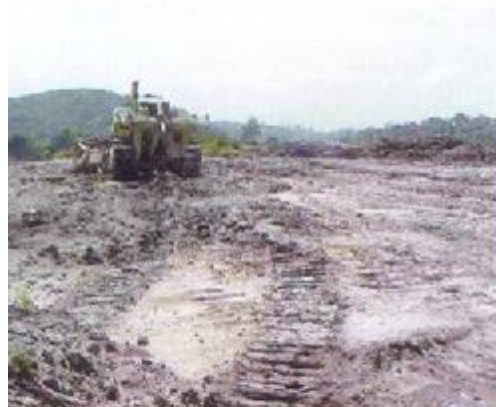
Painel lavrado e aterrado com rejeitos argilosos sendo coberto com estéril proveniente da lavra.
