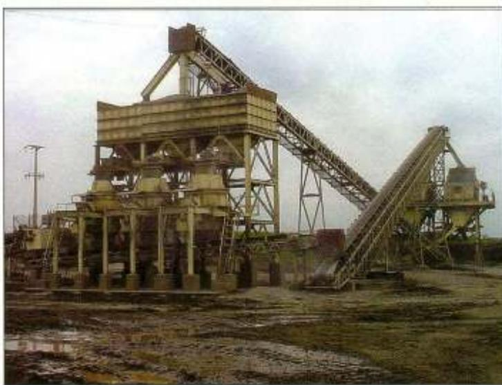
equipamentos, que não receberam arranjos ou configurações especiais. “A planta montada é constituída de equipamentos padrões da Metso”, explica. De toda a linha, os únicos modelos importados são os rebritadores Barmac 7100, fabricados pela unidade de Nova Zelândia. Toda a logística de importação ficou a cargo da Metso Brasil. “O suporte pós-venda pode ser constatado e aprovado no decorrer de toda essa operação de instalação”, conclui Mendonça.
