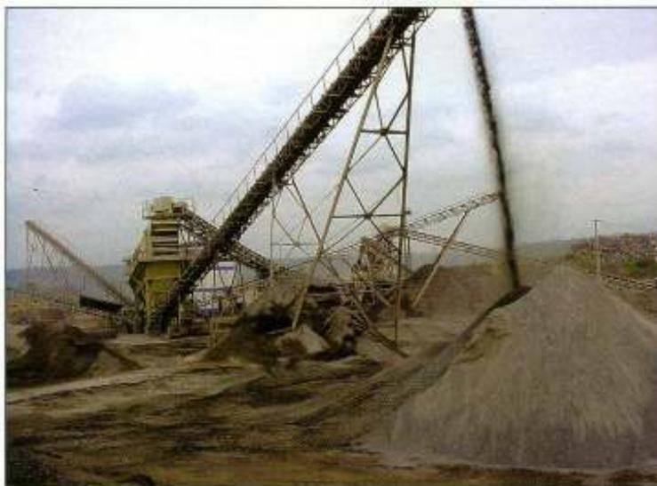
metros, 36" x 58 metros e 36" x 42 metros, respectivamente, com potência de 2 x 20,0 HP. Para a alimentação controlada dos Barmac 7100 foram adquiridos, também da Metso, dois silos metálicos com capacidade de 20 metros cúbicos cada, com transportadoras controladas por inversor de freqüência. A retomada de material
