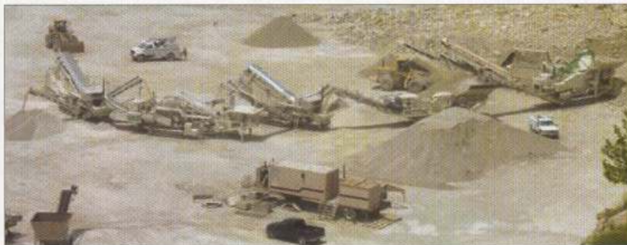
Instalação de britagem completa de três estágios montada na cava
