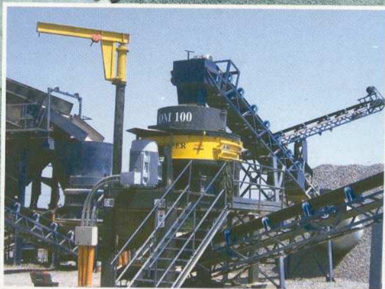
Tipo Autógeno (rocha-a-rocha) Indicado para o processamento de materiais com alto índice de abrasão.
