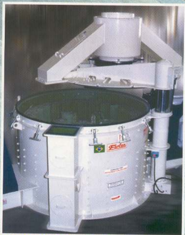
Tipo Impulsor/placa de impacto (aço-aço) Indicado para o processamento de materiais com baixo/médio índice de abrasão.
