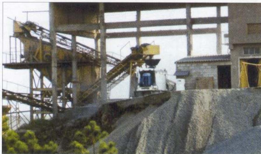
V.S.I. Furlan tipo aço-aço instalado na Basalto-Pedreira e Pavimentadora Ltda (Grupo Estrutural) em Limeira-SP., onde o minério processado é basalto.
