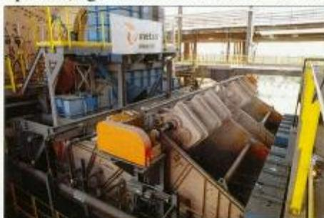
Peneira com vibrador tipo caixa de engrenagem LH-12'x24'DD - Mineração Serra do Sossego.
