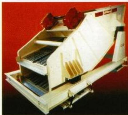
**Peneiras tipo banana:** As peneiras tipo banana possuem decks de inclinações variáveis ao longo do comprimento da peneira. No trecho da alimentação, começam com ângulos bem maiores que as inclinadas
