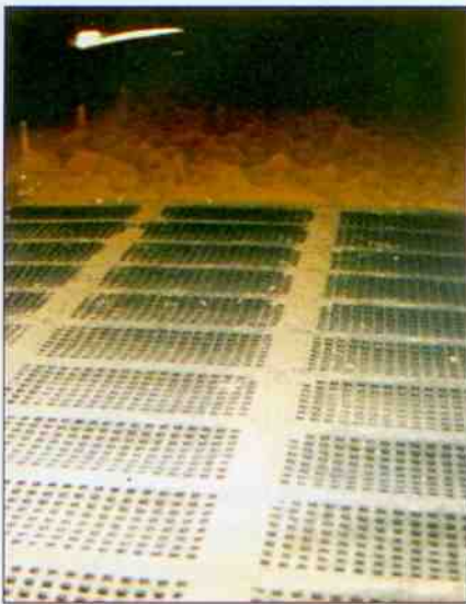
Tela de aço (entupida) e ao fundo tela de borracha flexível
