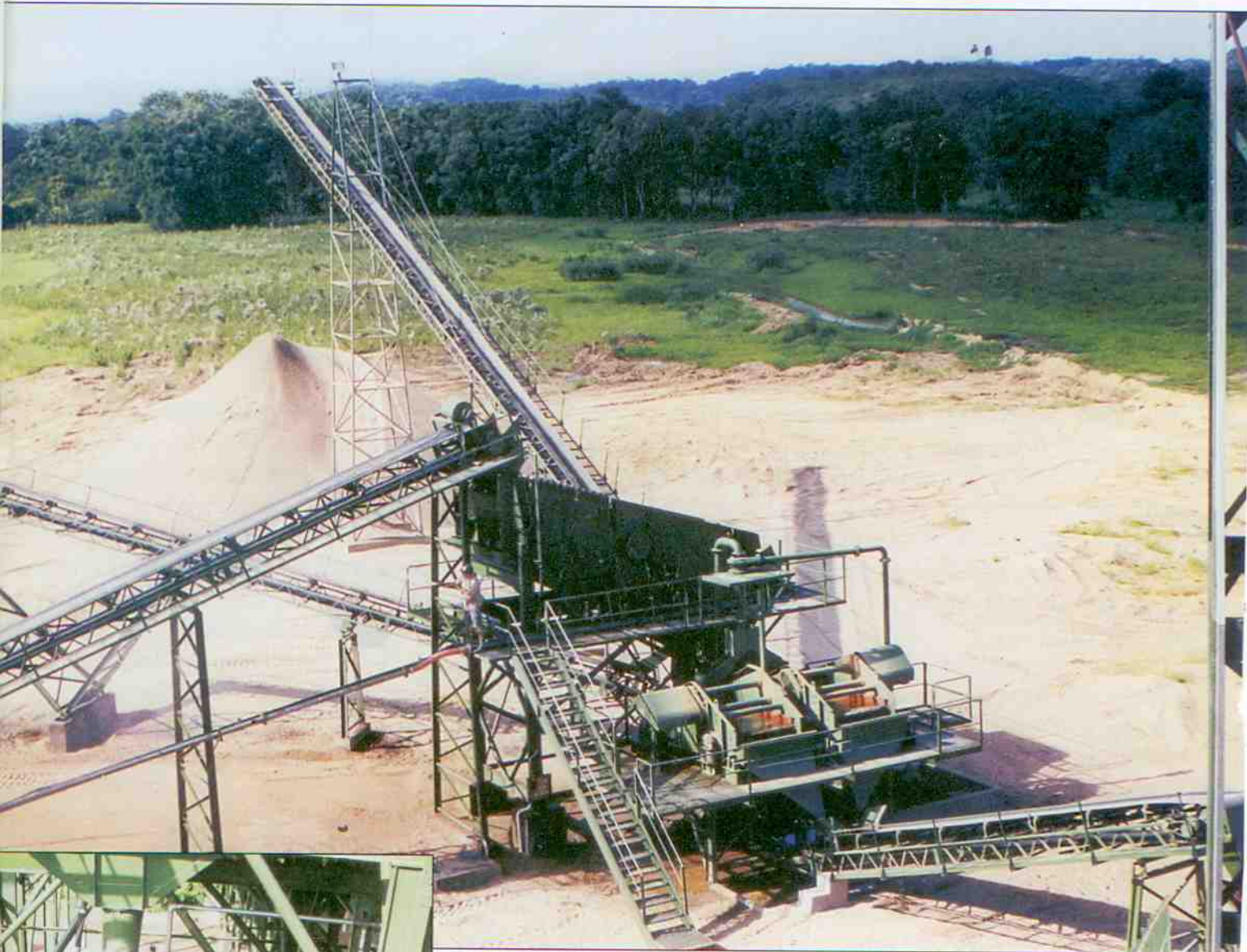
Peneiras vibratórias e desaguadoras permitem a separação granulométrica e a classificação das areias.
