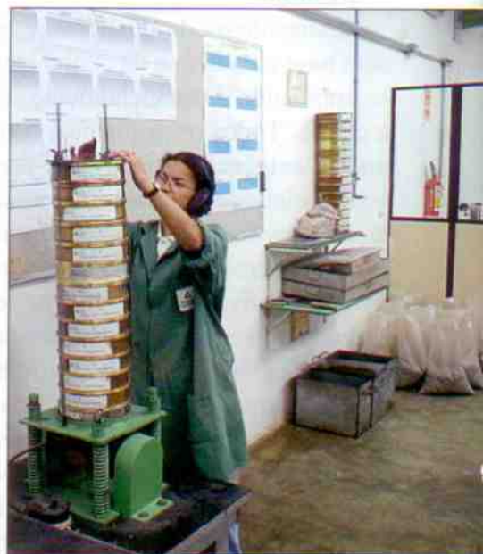
Equipamento utilizado nos ensaios de distribuição granulométrica da brita.
