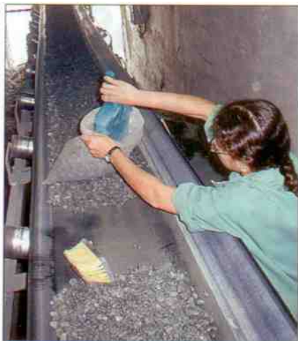
Coleta de amostra para determinação de indicadores da qualidade da brita.
