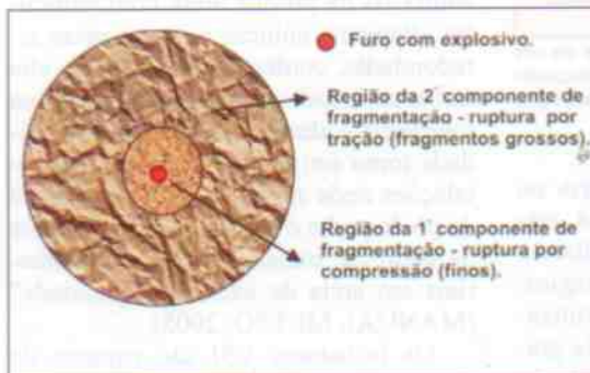
Figura 2 – Ilustração dos dois tipos de material proveniente de detonações (fonte: DJORDJEVIC, 1999).
