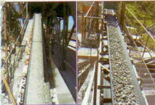
Figura 8 - Alimentação (esquerda) e produto (direita) do britador VSI (fonte: MUNIZ, 2006).
