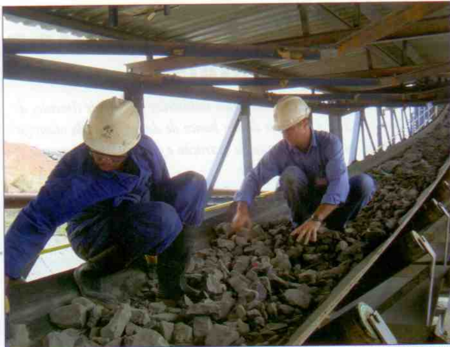
Amostragens dos circuitos de britagem e peneiramento para calibração dos modelos matemáticos e para ajuste das análises de imagens.
