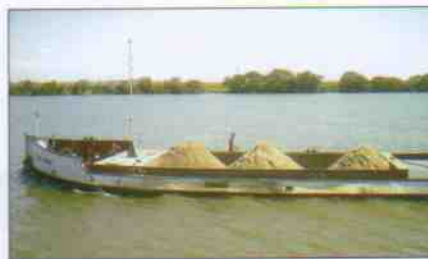
Barco transportando areia carregada em draga de Alcatruzes
