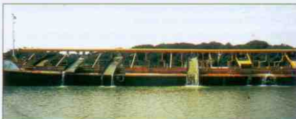
Draga de Sucção Auto-Transportadora
