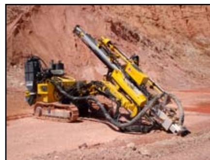
Perfuratriz hidráulica ROC D3 da Atlas-Copco
