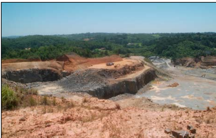
Vista da Pedreira Central – decapagem
