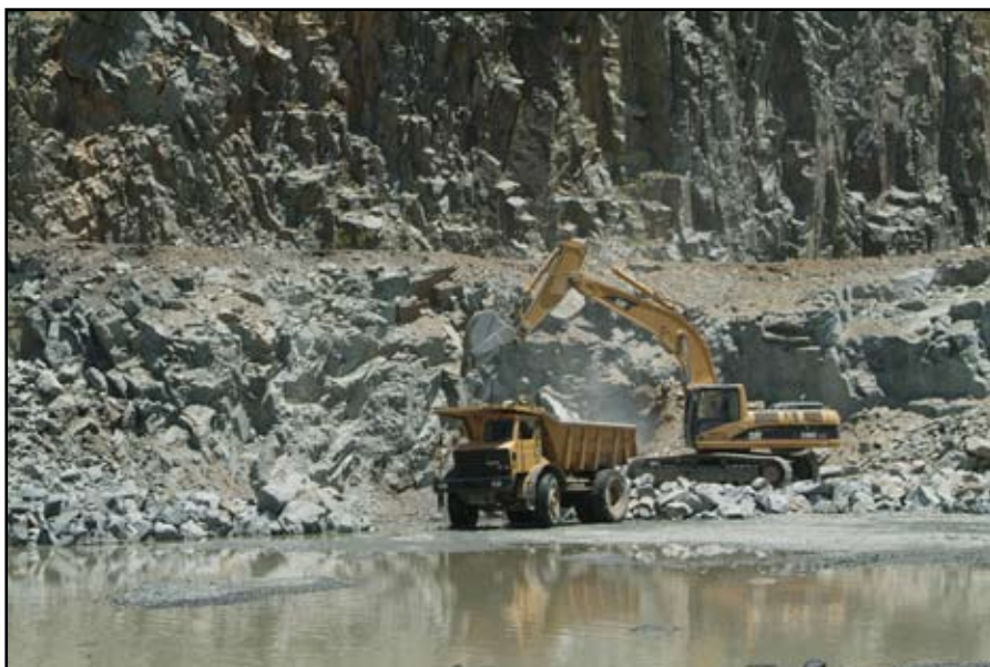
Carregamento da rocha – escavadeira sobre pilha
