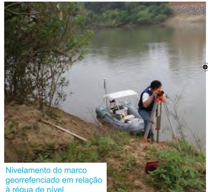
Nivelamento do marco georreferenciado em relação à régua de nível
