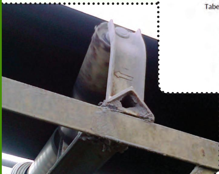
Na tabela 2 abaixo foram determinadas as variações dimensionais da espessura dos tubos. A espessura do tubo original de projeto é de 4,7mm.
