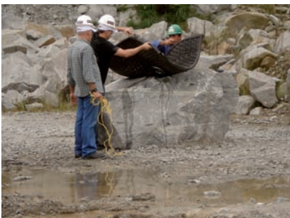
Manta sendo colocada
