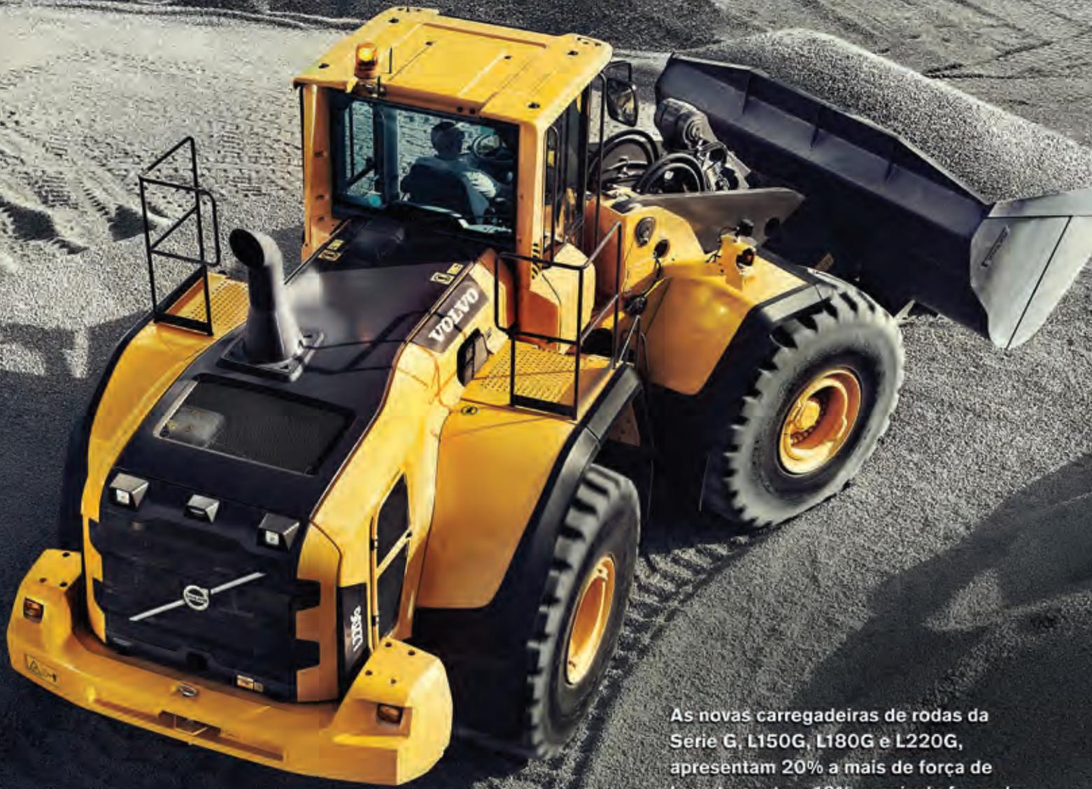
As novas carregadeiras de rodas da Série G, L150G, L180G e L220G, apresentam 20% a mais de força de levantamento e 10% a mais de força de desagregação. Os novos motores e transmissões proporcionam maior produtividade, menos emissões, maior facilidade de manutenção e ainda mais conforto para o operador. Caçambas cheias, tempos de ciclo mais rápidos e produtividade aumentada - o dia todo, todos os dias. [www.volvoce.com](http://www.volvoce.com)
