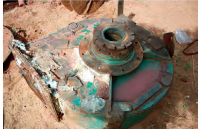
Como podemos ver na foto, a bomba é composta por várias chapas de aço, podendo ser revestida internamente. Também é possível notar que foram realizadas inúmeras intervenções com solda, massa plástica e troca de retentores com o intuito de prolongar a vida do equipamento.
