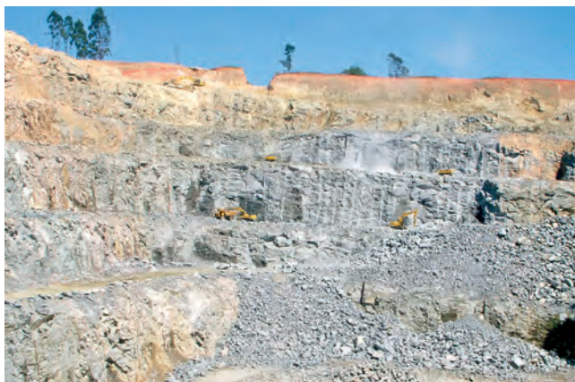
Exemplo de frente de lavra bem direcionada e carregamento de caminhões após detonação. No topo, pode-se observar a transição entre solo e rocha, a conhecida “rocha podre”, de qualidade inferior
