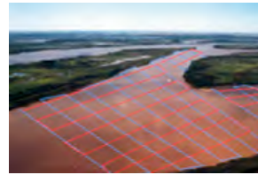
Figura 3 – Representação das seções de mapeamento batimétricos do rio
