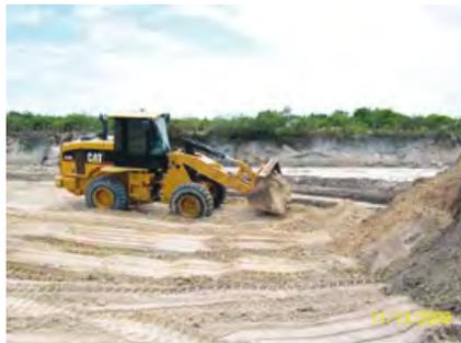
Figura 11 - Extração de areia fina por desmonte mecânico, Caucaia.
