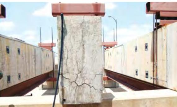
Efeito da reação álcali-agregado em viga de concreto
