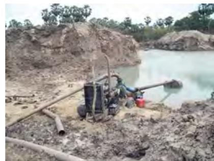
Figura 9 – Extração de areia por dragagem fixa na planície de inundação do rio Pacoti, Aquiraz.
