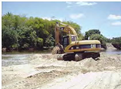
Figura 10 – Extração de areia grossa por desmonte mecânico no leito do rio Curu, São Luiz do Curu.
