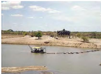
Figura 12 – Aspecto geral da dragagem, do beneficiamento e detalhe do silo desaguador utilizado em área de extração de areia grossa no rio Choró, município de Chorozinho.
