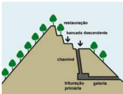
Figura 1 – Esquema de lavra por chaminé-galeria e bancadas descendentes
