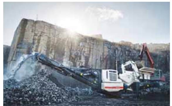
A nova planta de britagem por mandíbulas Lokotrack LT106 conta com um motor Tier 3/Tier 4 de baixa emissão e excelente economia de combustível.
