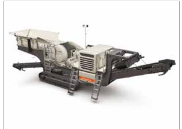
O LT106 é construído com base no comprovado britador de mandíbulas C106, com mais de 2.000 referências no mundo inteiro.
