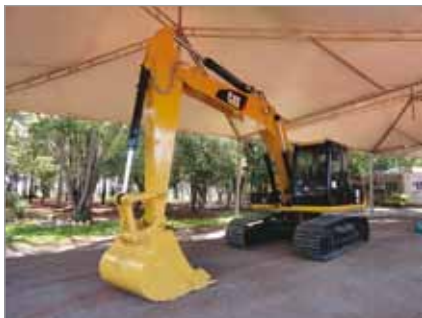
Escavadeira hidráulica 318D2L
