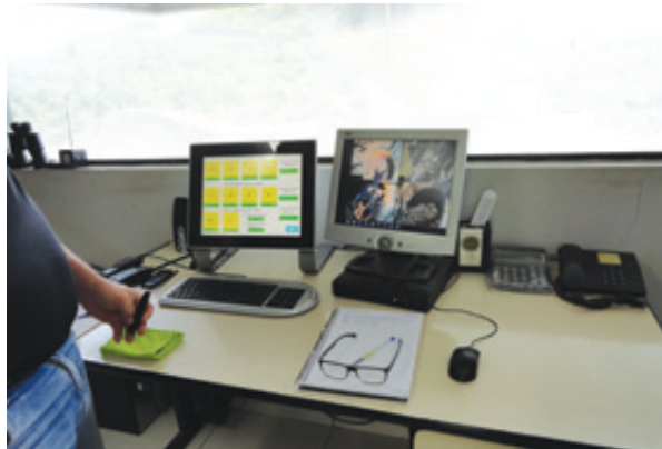
Técnico monitora automaticamente funcionamento de britadores e peneiras.
